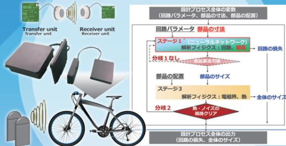
ワイヤレス電力伝送における部品寸法を考慮した回路パラメータの最適化プロセス (ニューラルネットワークの活用)
